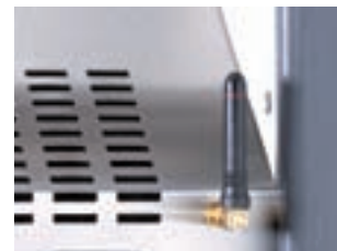
Funksteuerung mit Antenne und Sender (HP 50 Funk)
