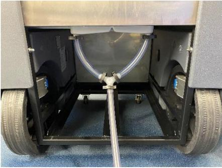
Bei Aktivierung des Modus „direkter Ablauf“ werden die Wasserstandsensoren der Tanks deaktiviert! Dadurch wird die Abschaltung des Gerätes und die Fehlermeldung bei vollen Tanks unterdrückt.
